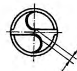
Querschneidenlänge 10% vom Bohrer - Ø
