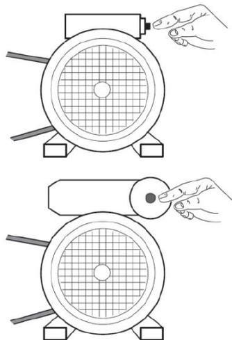
Abb. 10: Motorschutzschalter bei 230 V-Modellen
