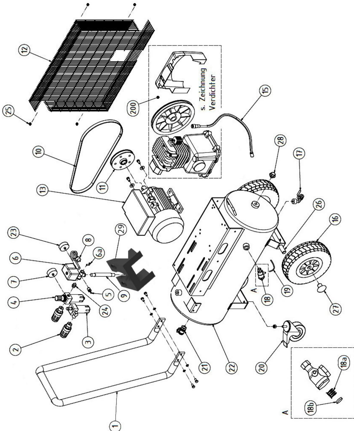
Abb. 24: Ersatzteilzeichnung 1 - AIRPROFI 401/50 P, AIRPROFI 403/50 P, AIRPROFI 503/50 P und AIRPROFI 503/100 P
