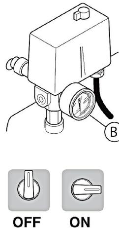
Abb. 11: EIN-/AUS-Schalter auf dem Druckschalter
