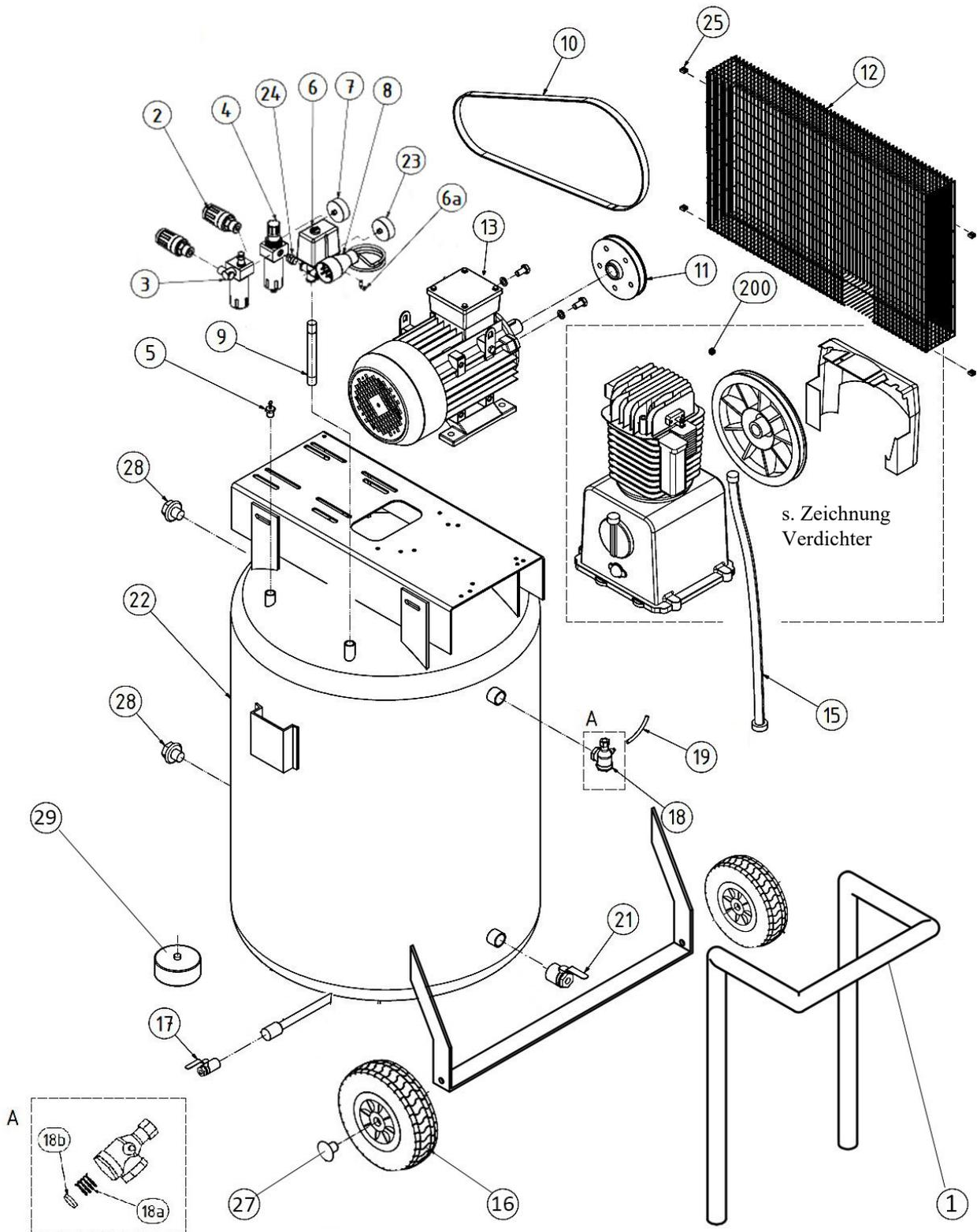
Abb. 25: Ersatzteilzeichnung 1 - AIRPROFI 401/90 V, AIRPROFI 403/90 V und AIRPROFI 503/90 V
