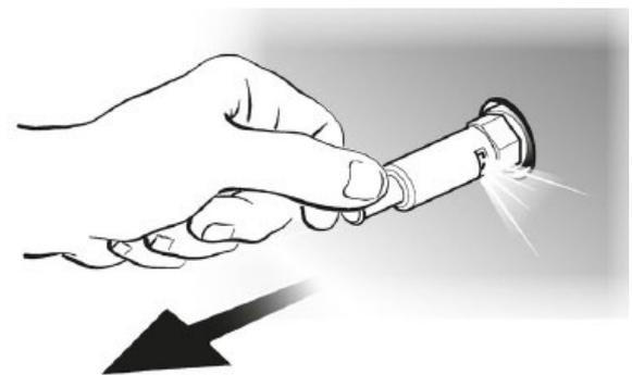
Abb. 22: Sicherheitsventil mit Schelle
