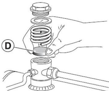
Abb. 20: Dichtelement im Rückschlagventil
