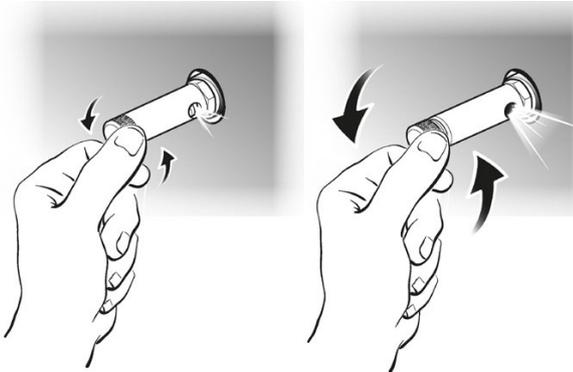
Abb. 23: Sicherheitsventil mit Ringmutter
