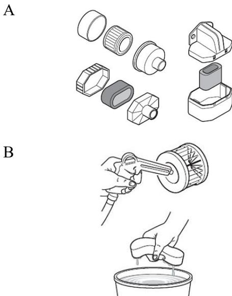
Abb. 17: Reinigung Luftfilter
