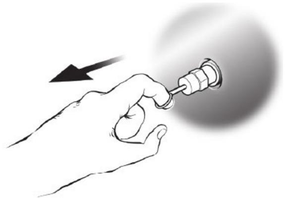
Abb. 21: Sicherheitsventil mit Ring
