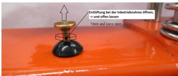
Abb. 4: Entlüftungsventil
