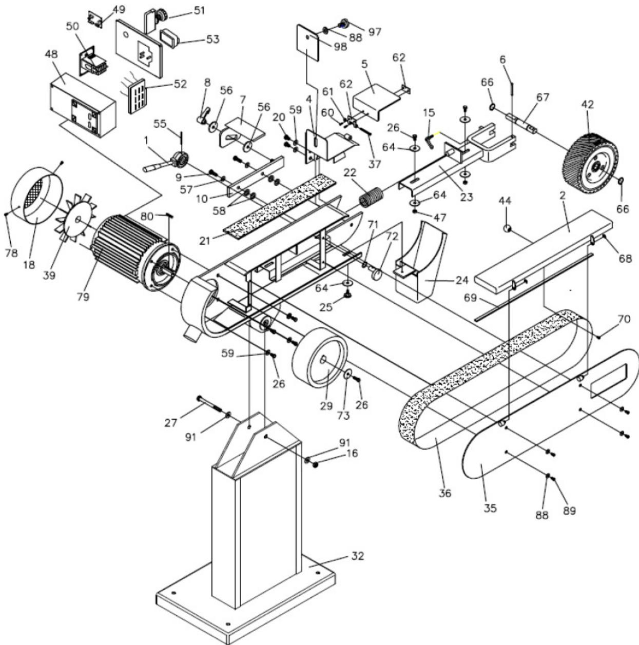
Abb. / Fig. 1: Ersatzteilzeichnung / Spare Parts Drawing MBSM 75-20 und / and MBSM 150-20
