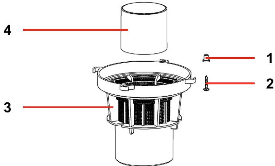
Abb. / Fig. 2: Ersatzteilzeichnung 2 / Spare Parts drawing 2
