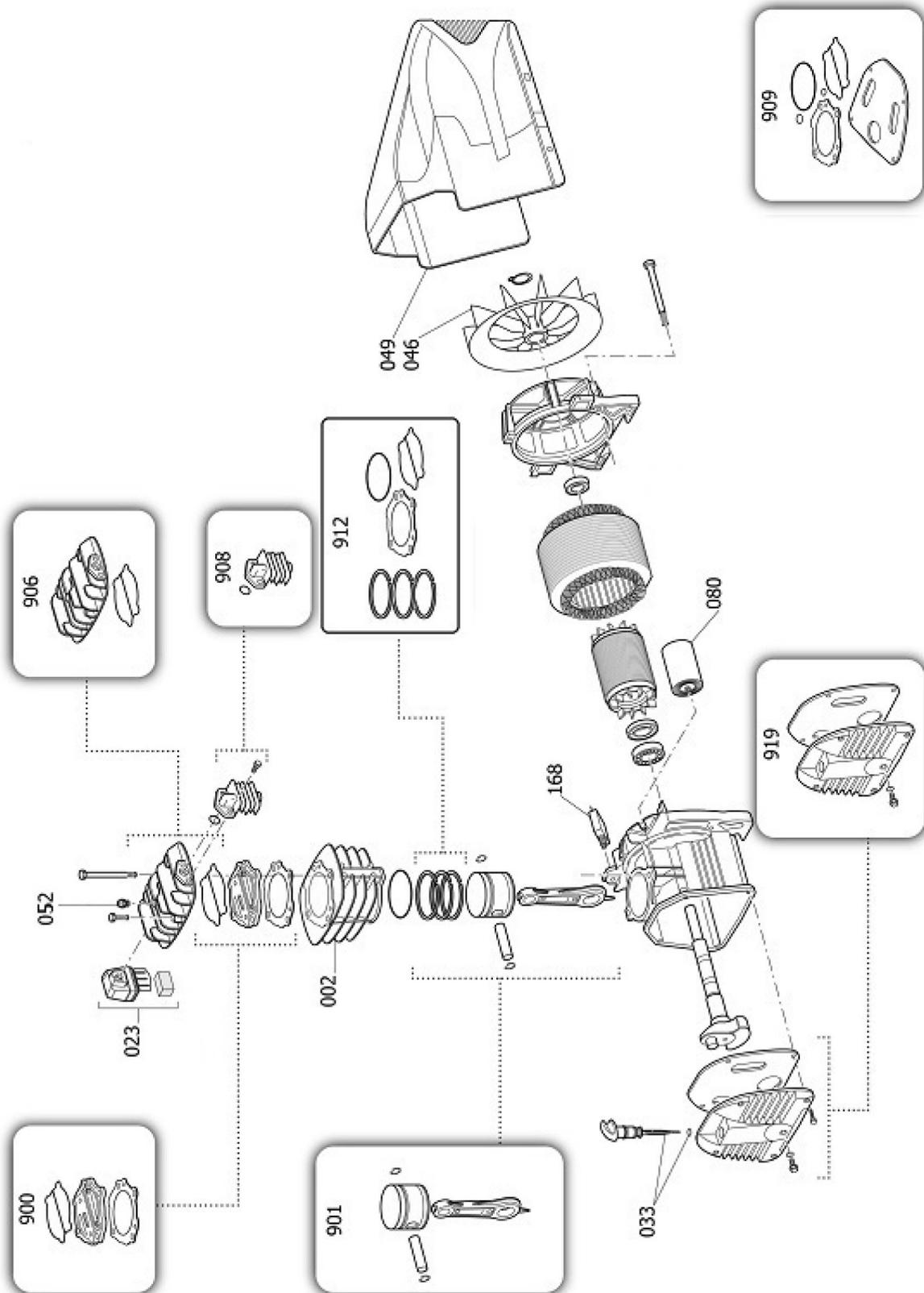
Abb./Fig. 3: Ersatzteile Verdichter MK 265 / Spare parts Compressor MK 265
