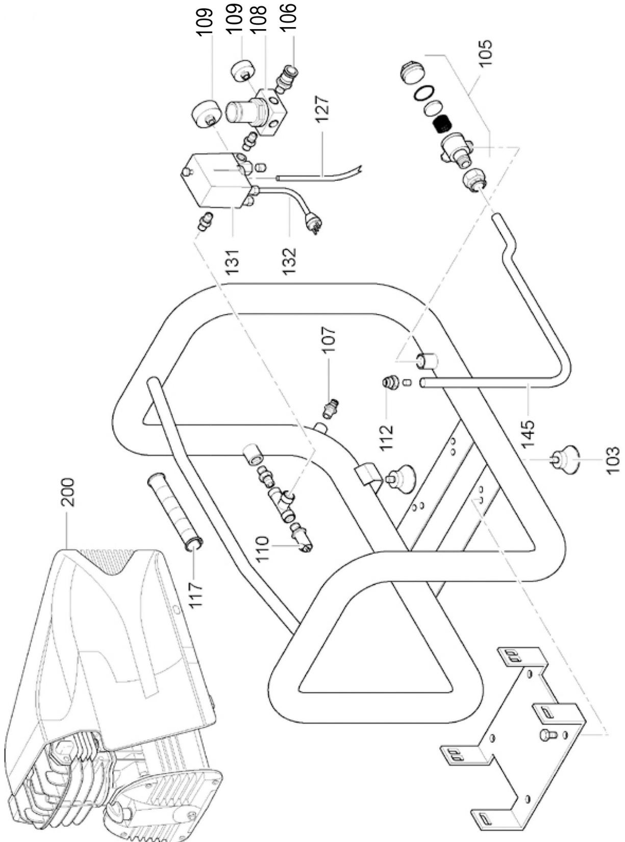
Abb./Fig. 4: Ersatzteile Gehäuse / Spare parts housing
