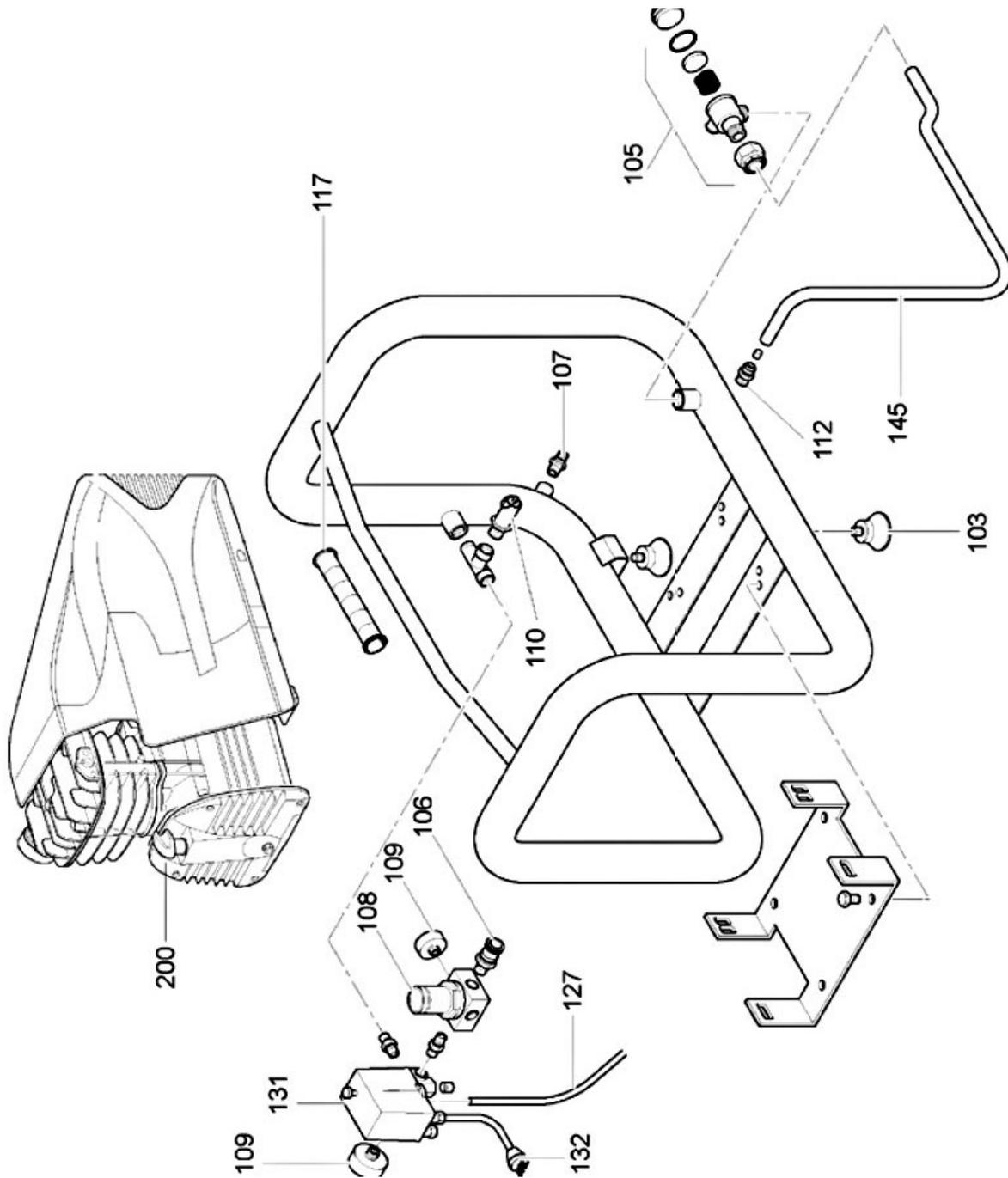
Abb./Fig. 2: Ersatzteilzeichnung 2 - AIRBOY KITT 90 / Spare parts drawing - AIRBOY KITT 90
