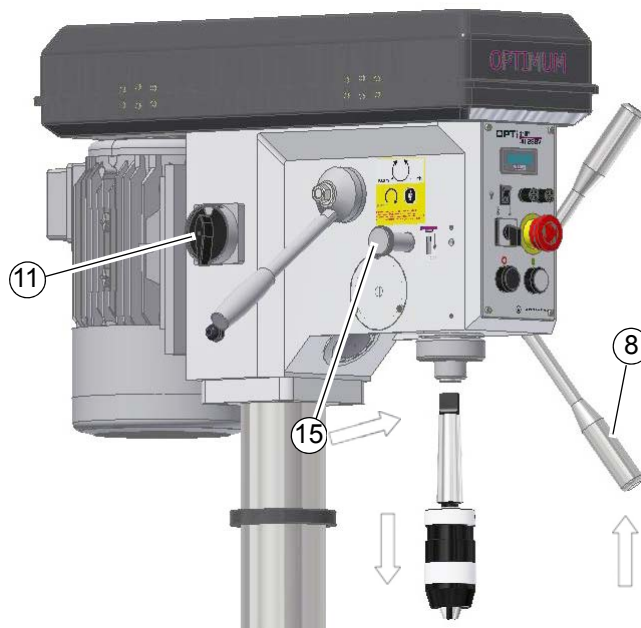
Abb.4-7: Ausbau mit integriertem Austreiber
