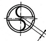
Querschneidenlänge 10% vom Bohrer - Ø
