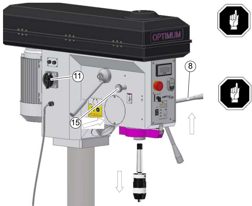
Abb.4-11: Ausbau mit integriertem Austreiber
