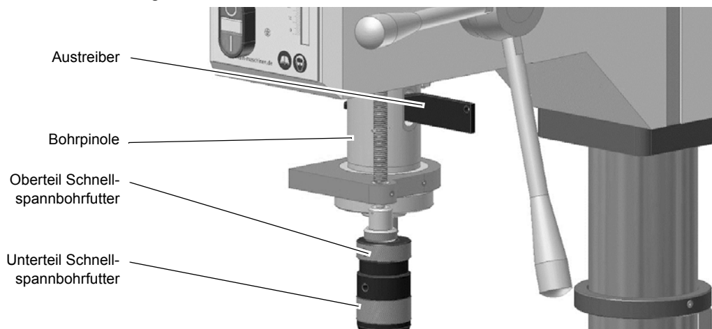
Abb.4-8: Ausbau mit Austreiber
