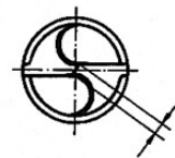
Querschneidenlänge 10% vom Bohrer - Ø
