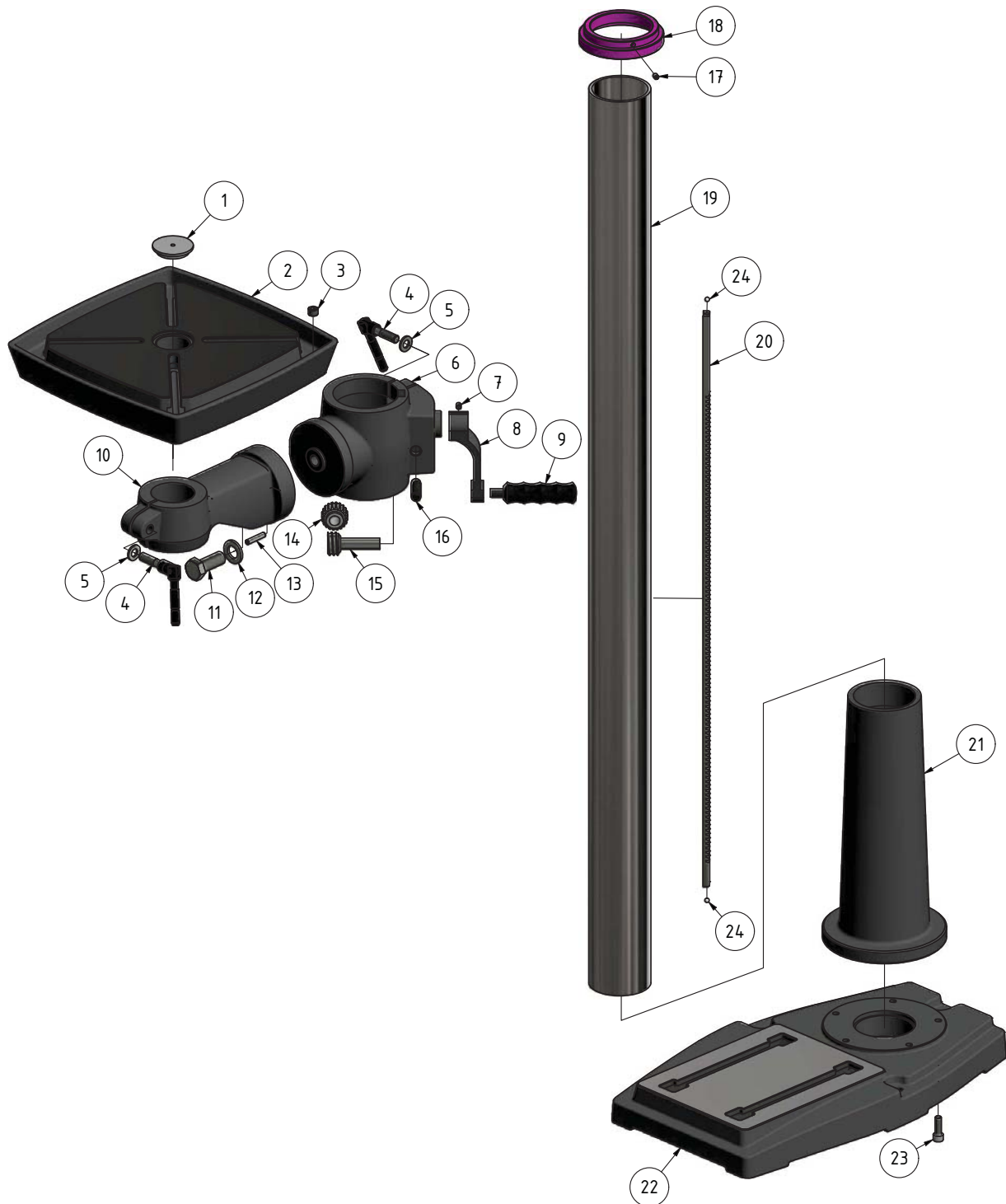
8-4: Säule, Bohrtisch - Column, drilling table
