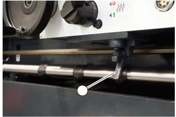
Mechanische Längsvorschubabschaltung Bettschlitten
