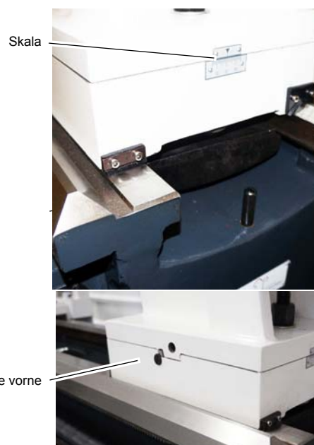
Abb.4-10: Querversetzen des Reitstocks
