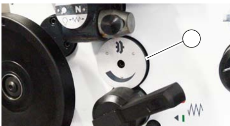
Einstellung Kupplungskraft Vorschub
