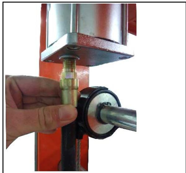
Abb. 15: Druckluftverbindung montieren
