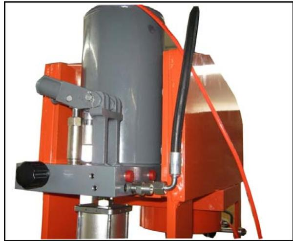
Abb. 13: Der kurze Schlauch montieren
