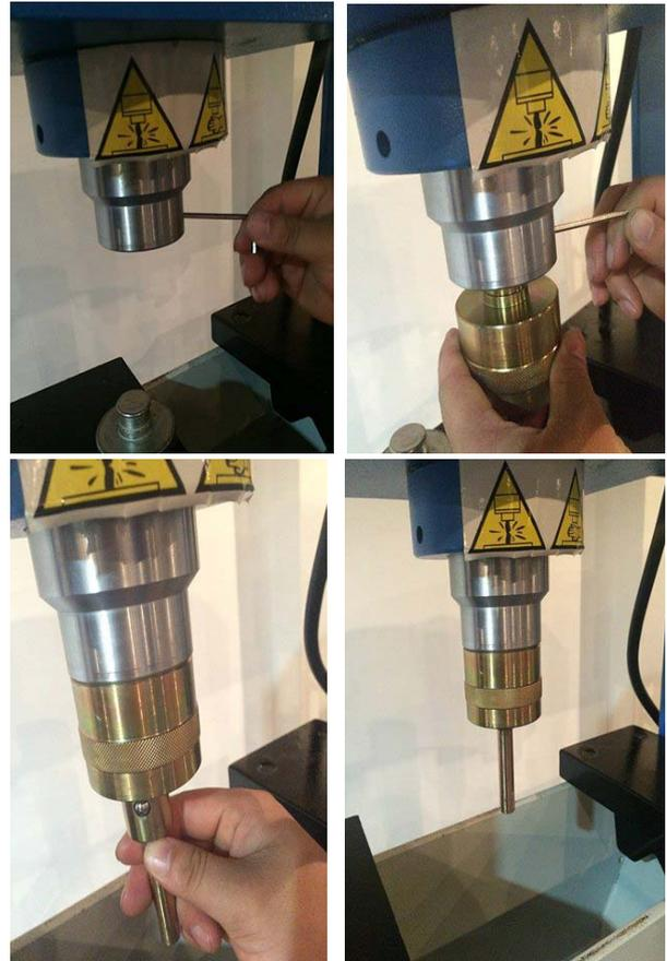
Abb. 17: Druckdornsatz montieren
